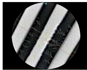
图 3. 引线框封装内部标识了树突 — 经过 2,000 小时的高温、高湿度鉴定测试后，封装零件形成微小泄漏。ELITE 系统在未进行开封检查的情况下在封装内找到了热点。X 射线将这些树突标识为根本原因。
